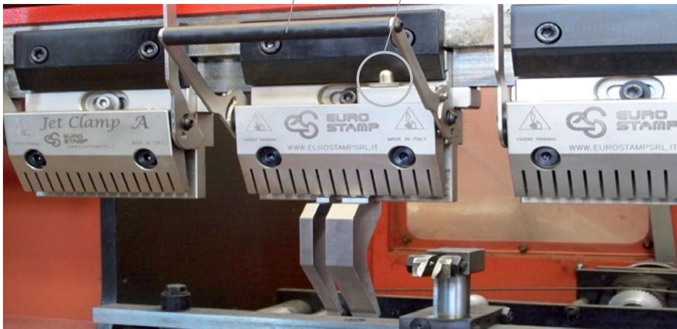
**Il nuovo sistema Jet Clamp** per il fissaggio meccanico degli utensili tipo Amada-Promecam, presenta alcune innovative soluzioni per velocizzare le operazioni di cambio utensili, riducendo al minimo i tempi di SET-UP e consentendo il carico/scarico frontale degli utensili.
